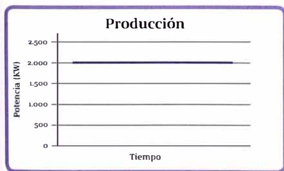
OptiSpeed® permite una variación de las velocidades de giro del rotor de un 60% aproximadamente en relación con la velocidad nominal. Así, con OptiSpeed®, la velocidad del rotor puede variar hasta un 30% por encima o por debajo de la velocidad sincrónica. Esto reduce las fluctuaciones no deseadas en la producción suministrada a la red eléctrica y minimiza las cargas en las partes esenciales del aerogenerador.
