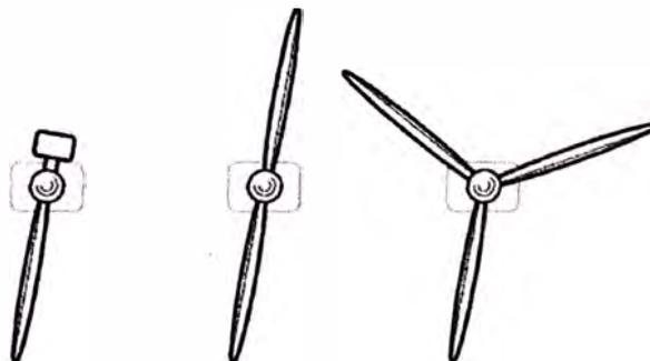
**Fig 2.4.-** Turbinas de 1,2 y 3 palas
