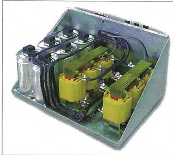
**Fig. 4.5** Filtro de rechazo compuesto por reactancias y condensadores
