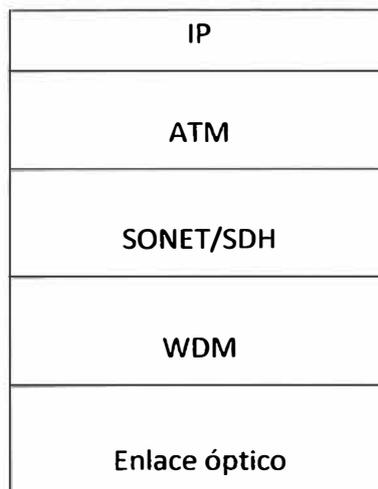
**Fig.2.42** Encapsulamiento clásico de protocolos
