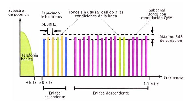
Fig. 2.13 Espectro de frecuencias de banda estrecha ampliado para ADSL [21]
