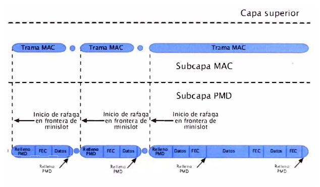
Fig. 2.22 Transmisión en sentido ascendente en redes HFC [21]
