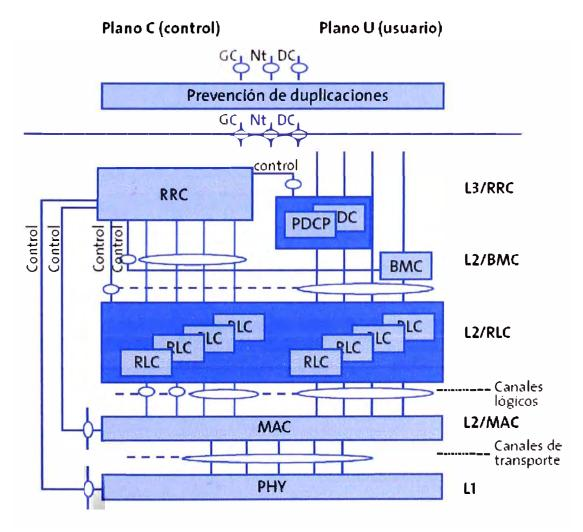
Fig. 2.27 Planos de control y de usuario en la interfaz de radio [22]
