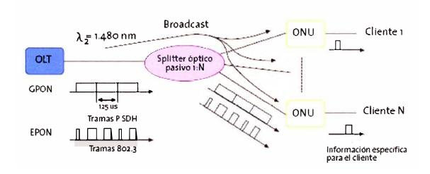
Fig. 2.11 Comunicación EPON y GPON en sentido downstream [19]
