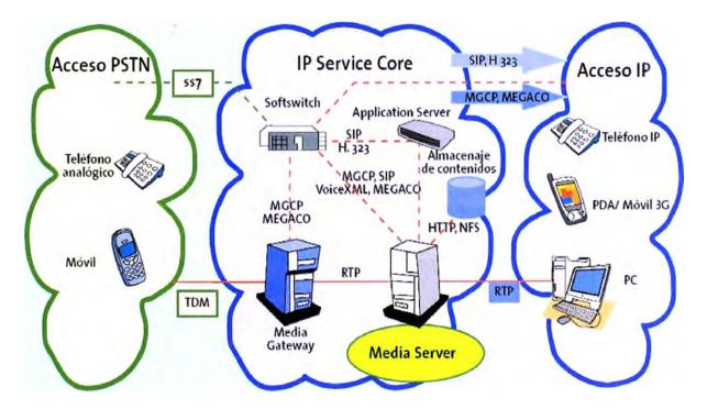
Fig. 3.2 Interconexión de elementos en la NGN [22]
