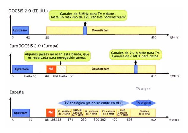
Fig. 2.19 Bandas de frecuencias en redes de cable [21]
