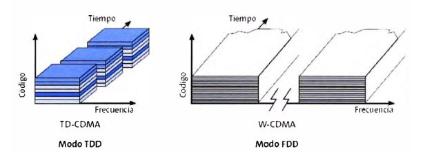
Fig. 2.26 Comparación entre FDD y TDD [22]
