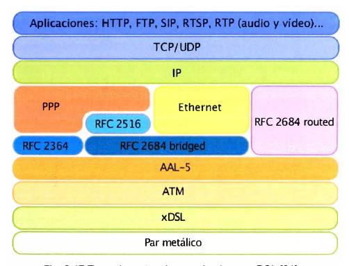
Fig. 2.17 Torre de protocolos empleados en xDSL [21]
