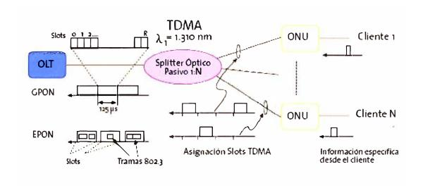
Fig. 2.12 Comunicación EPON y GPON en sentido upstream [19]
