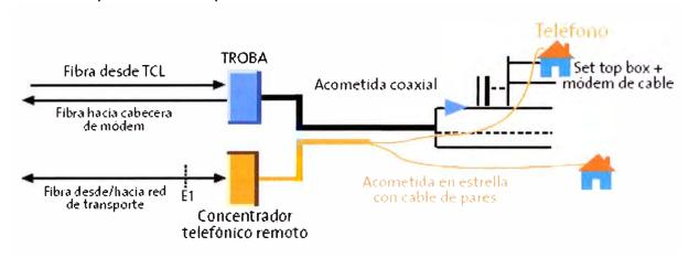
Fig. 2.23 Acometida de redes superpuestas HFC y par telefónico [21]
