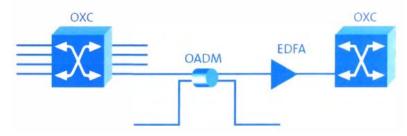
Fig. 2.4 Elementos de una red todo óptica [13]
