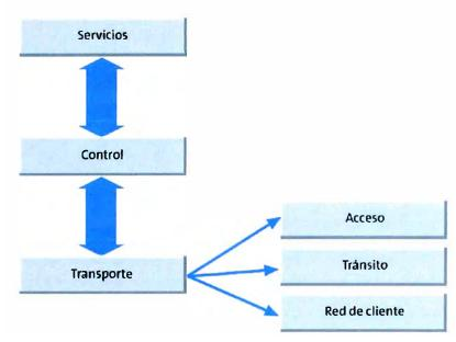
Fig. 2.2 Estructura de Capas del nuevo modelo de Red [13]
