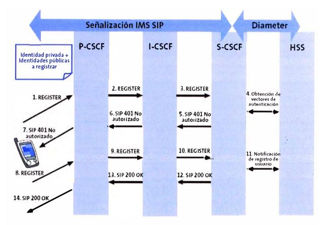
Fig. 4.2 Procedimiento de registro en IMS [24]
