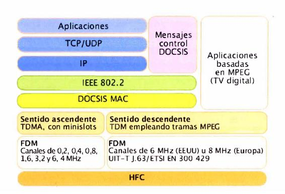
Fig. 2.20 Torre de protocolos usado en HFC [21]
