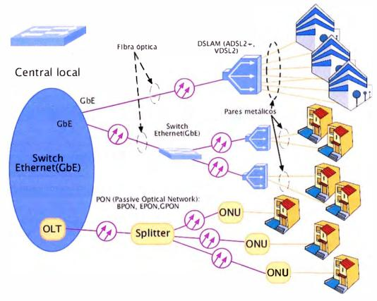
Fig. 2.18 Estructura de acceso híbrida: fibra óptica más par de cobre [21]
