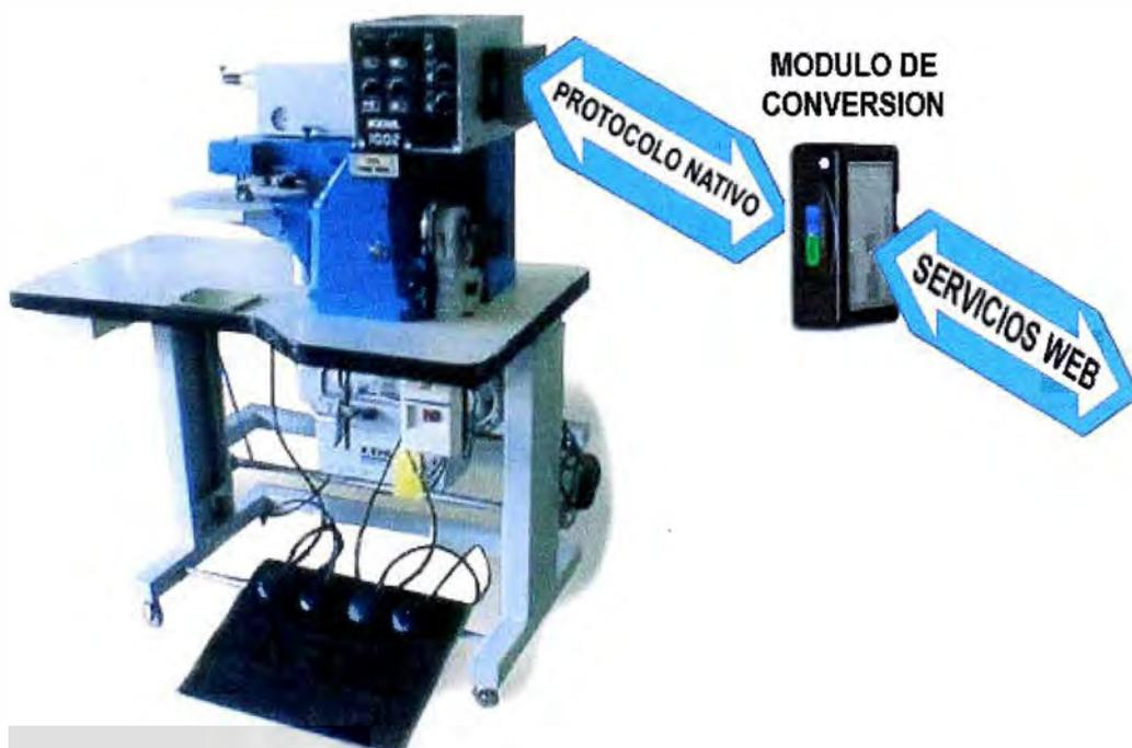
Fig. 4.7 Máquina electrónica de dobladillar cortes de cuero
