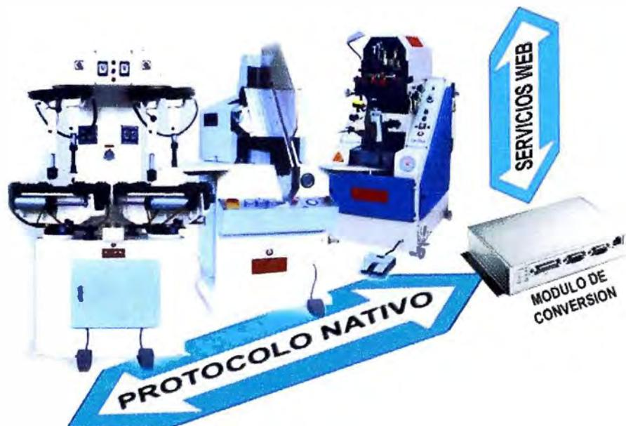
Fig. 4.8 Línea de producción convertida a Servicios Web
