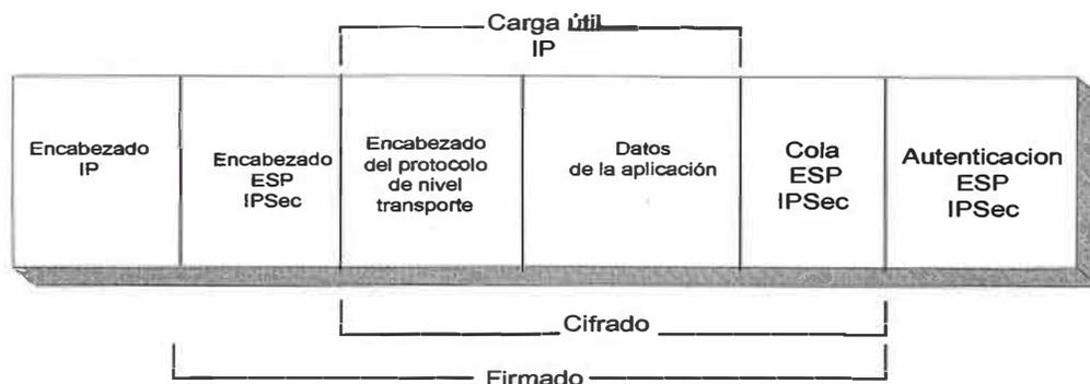
**Figura 2.12 Ubicación del encabezado y de la cola ESP**
